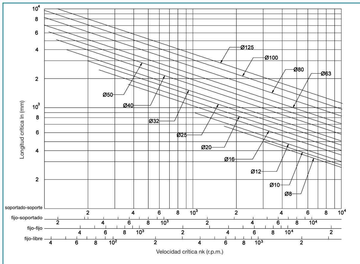
Al igual que todo eje en rotación, los husillos de bolas deben girar por debajo de un valor de velocidad crítica. La velocidad crítica depende del diámetro del husillo, de la configuración del montaje y de su longitud  $l_n$ .
